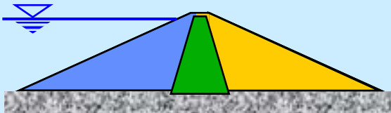
Corps aval très perméable
