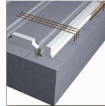
Plancher Hourdis Béton Rupteur Total : Stoptherm EB
