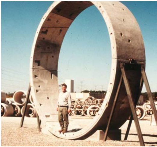
Voutre pour tunnel -ciment avec FS pré-melangé plus latier, pour reduire penetration des ions chlore
