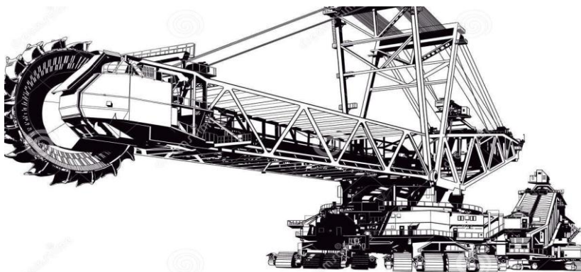
Fig 47: Excavateur à godets multiples
