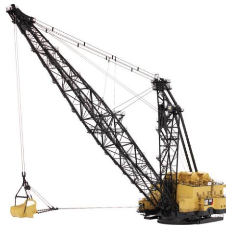
Pelle mécanique en dragline.
