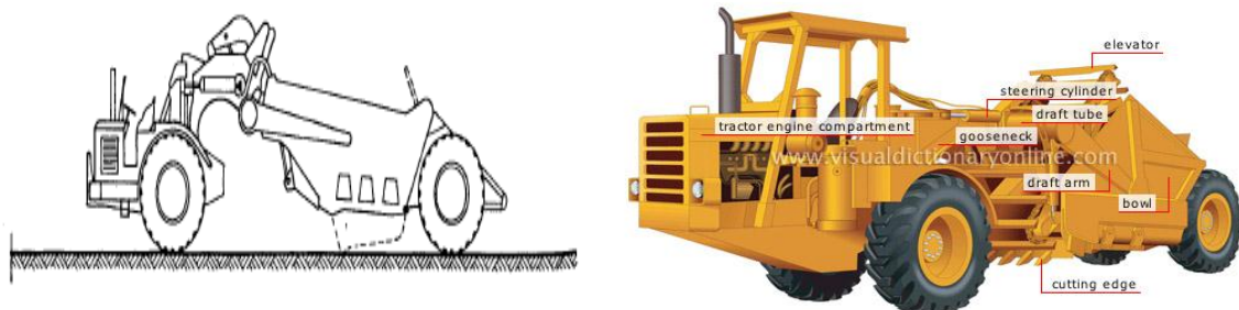
Fig 53: La décapeuse ou scraper
