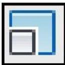
L'outil "Echelle" permet de multiplier ou de diviser la valeur géométrique d'un ou de plusieurs objets. Cet outil est généralement utilisé pour agrandir un détail géométrique qui n'est pas totalement visible sur un plan.
