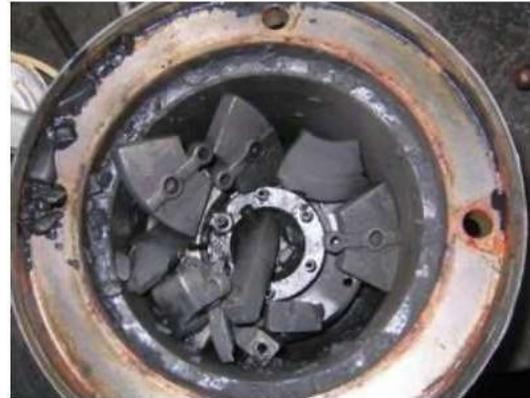
Rupture des aubes d'une pompe
