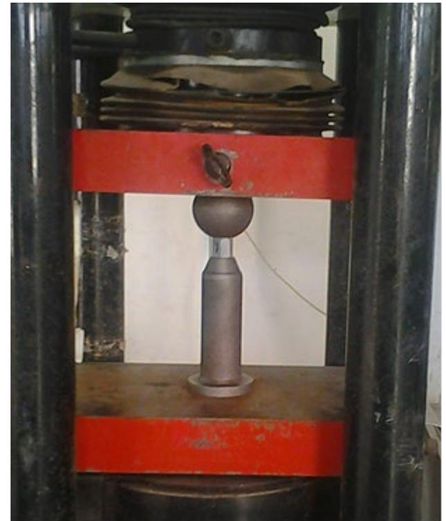
*Dispositif expérimental d'essais de compression*
