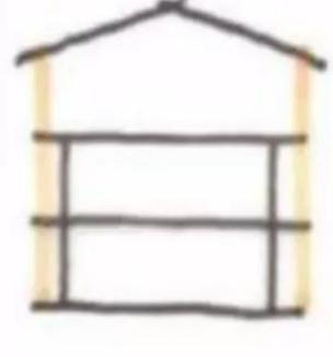
③ Structure béton auto stable dalle béton et panneau ossature bois entre dalle
