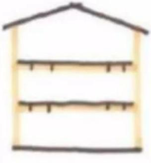
② Structure bois verticale et horizontale, béton connecté (solution des planchers mixtes)
