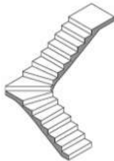
Escalier à quartier tournant médian
