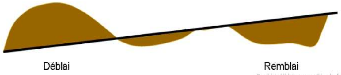
Figure 2: Représentation du Remblai et du déblai
