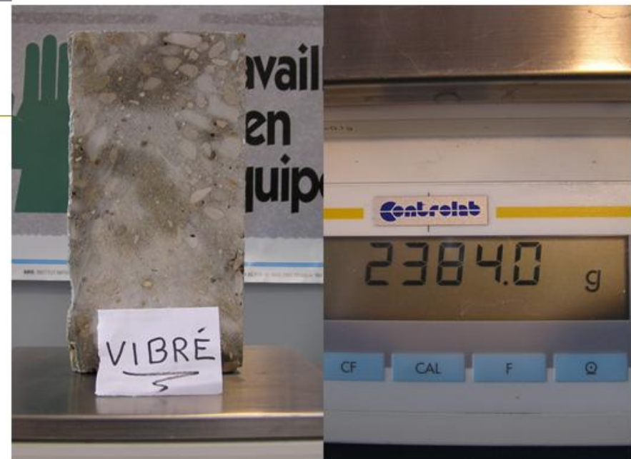
pour le béton vibré m=2.384\text{Kg}
