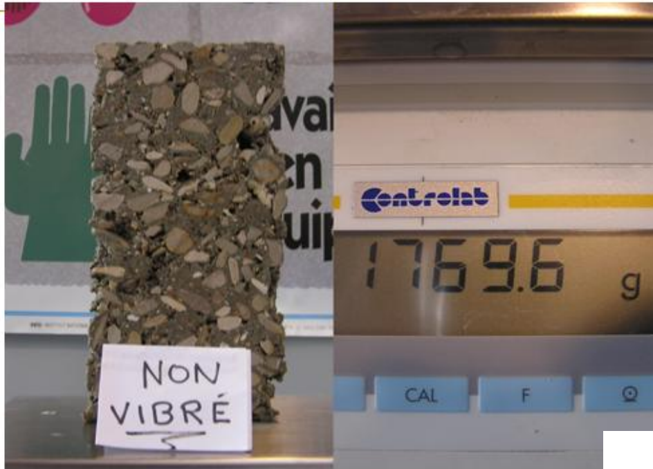
béton non vibré m=1.7696\text{Kg}
