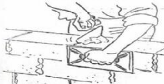
14. Bourrer les joints verticaux.
