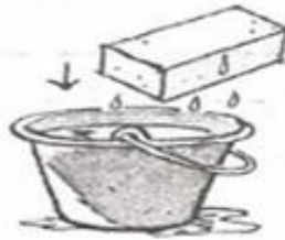
11. Tremper les blocs juste avant de les poser.
